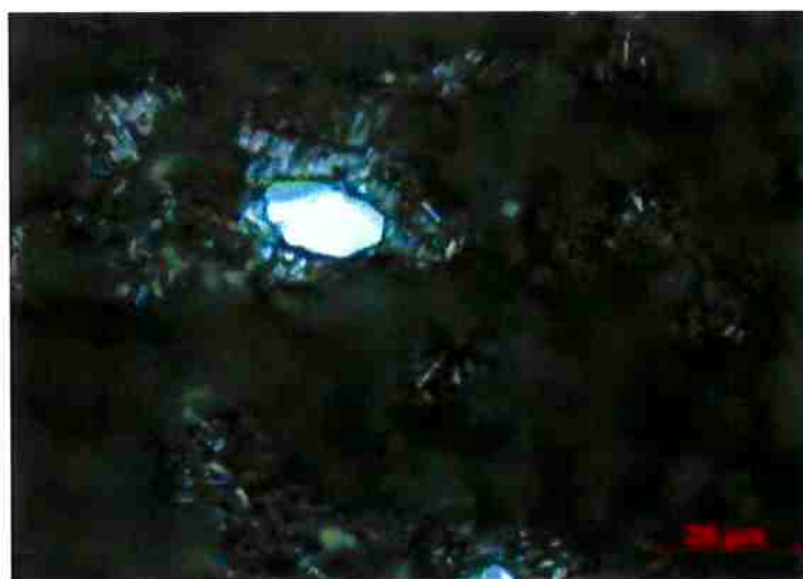
Figura 32 - Microscopia ótica de amostra com “poça” de zinco residual após tratamento térmico a baixa temperatura.
